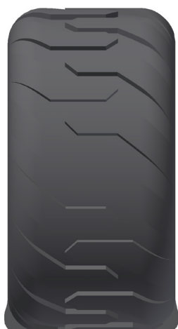
Falta de pressão
